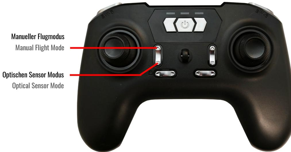
Durch Drücken der Taste für den manuellen Modus wird der optische Flugmodus deaktiviert. In diesem Modus leuchtet die Statusanzeige des Fluggeräts durchgehend rot, und die Höhenbeschränkung wird aufgehoben. Die maximale Fluggeschwindigkeit kann bis zu 10 Meter pro Sekunde betragen. Bitte beobachten Sie das Fluggerät genau und fliegen Sie vorsichtig.
